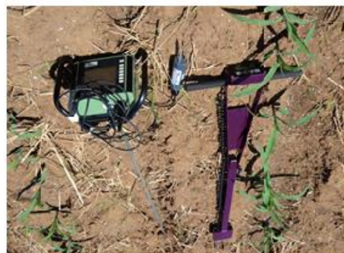
Figura 2-3: Penetrologger Eijkelkamp, con sonda de humedad DELTA (Izq.) y TDR Fieldscout (der.).
