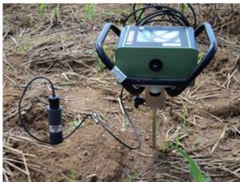
Figura 2-3: Penetrologger Eijkelkamp, con sonda de humedad DELTA (Izq.) y TDR Fieldscout (der.).
