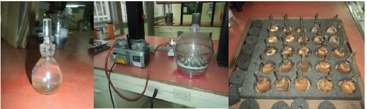
Figura 2-9: Metodología para hallar densidad real, muestra en pipeta (izq.); equipo para hallar densidad real (centro); muestras (der).
