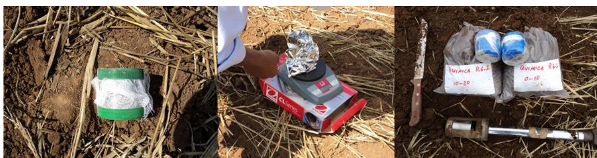
Figura 2-4: Muestra inalterada (cilindro metálico, izq.), muestras alteradas (humedad campo centro, atributos químicos der.).
