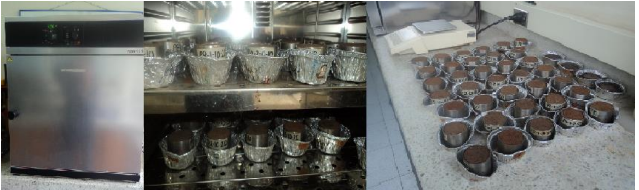
Figura 2-8: Metodología para hallar densidad aparente, muestras en el horno a 105°C (izq.); muestras inalteradas (der).
