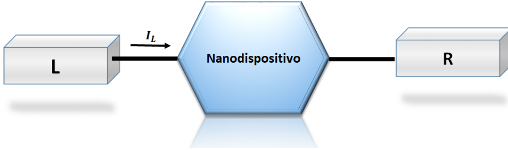
Figura 2-2.: Nanodispositivo conectado a dos electrodos (Electrodo Derecho (R) y electrodo Izquierdo (I)), por el cual circula una corriente I_L , la cual viaja desde el electrodo izquierdo hasta el derecho.
