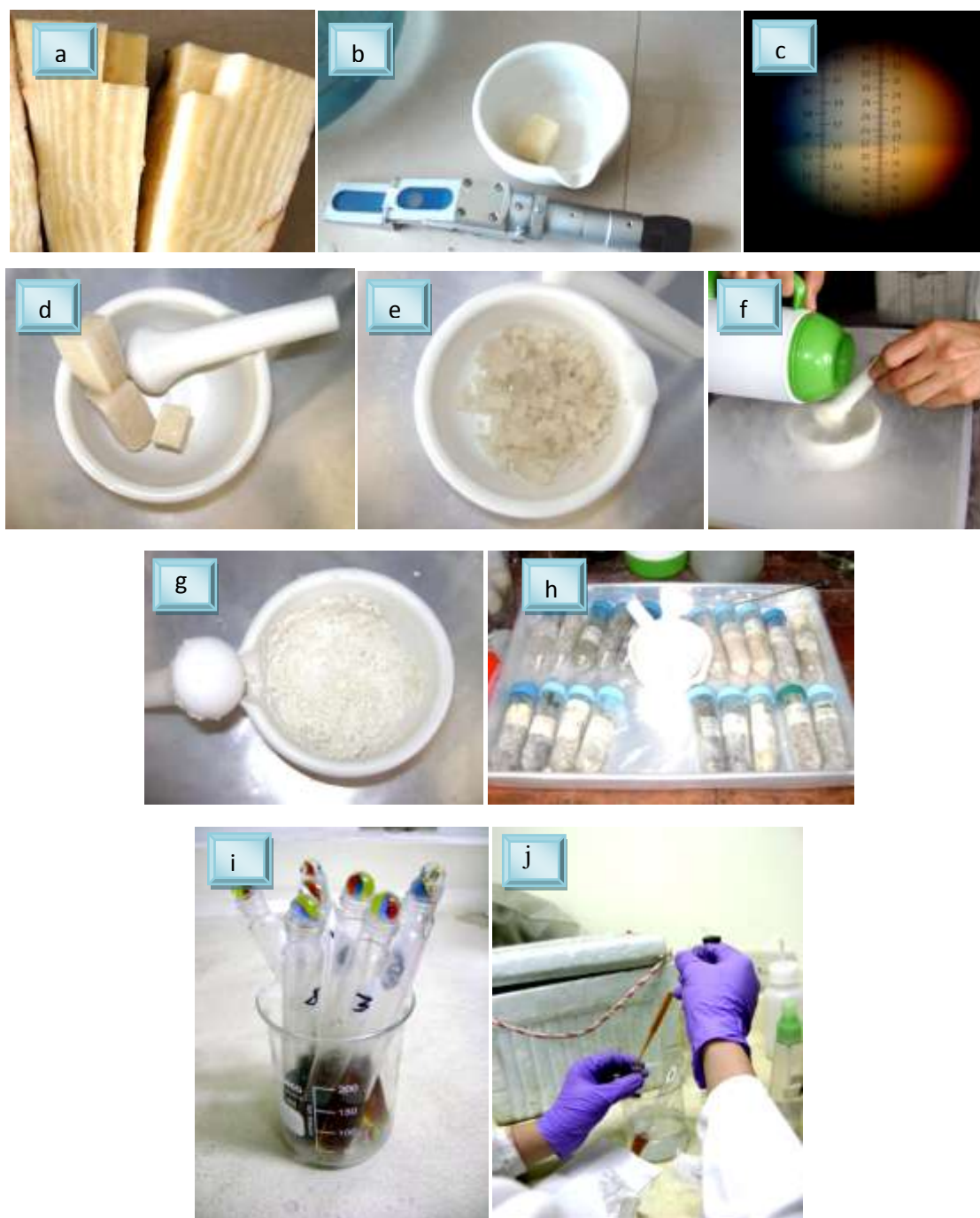
Figura 8. Procesamiento de muestras de tejido radical para determinación de azúcar. a. corte de muestras entre el primer y segundo anillo cambial secundario al nivel del ancho máximo radical; b. toma de muestras isomorfas para la determinación de °Brix; c. Lectura de °Brix sobre el jugo extraído de la muestra; d. Corte de 3 plantas por variedad para cada fecha; e. macerado en fresco a baja temperatura; f. macerado con nitrógeno líquido; g. muestra triturada y congelada; h. muestra almacenada; i. pos-reacción en tubos de ensayo, en etapa de enfriamiento; y j. extracción con micropipeta hacia la celda de cuarzo que se ubicó en el espectrofotómetro.
