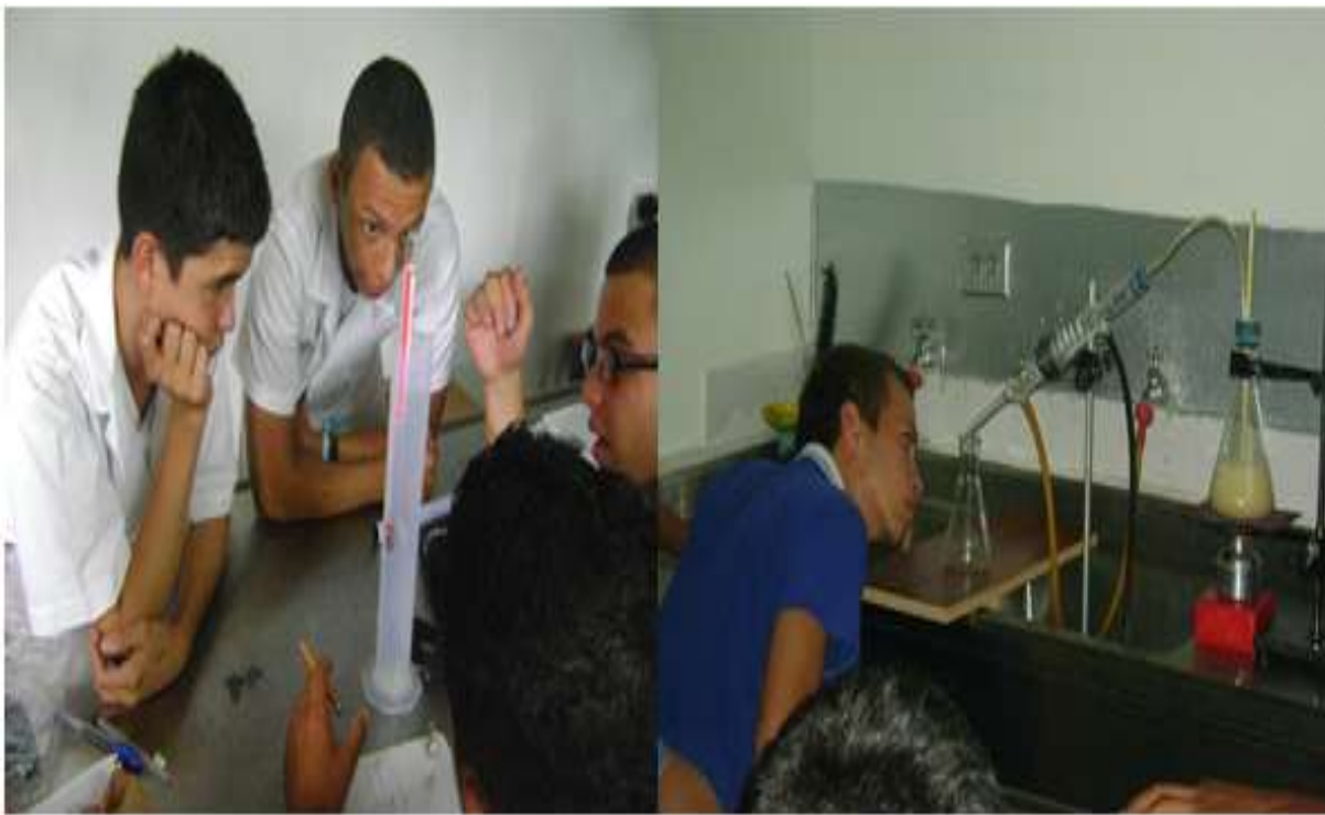
Ilustración 4 : Estudiantes de 11º2 realizando la medición de la densidad de las soluciones alcohólicas y la destilación del etanol.
