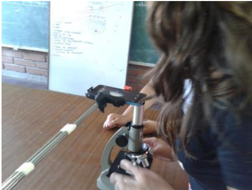
Foto 12. Adaptación de un teléfono celular tipo Smartphone a un microscopio óptico escolar.
