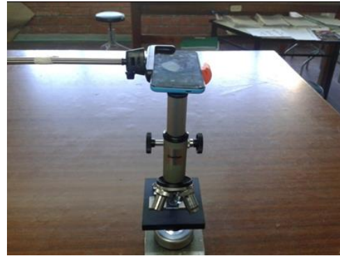
Foto 12. Adaptación de un teléfono celular tipo Smartphone a un microscopio óptico escolar.
