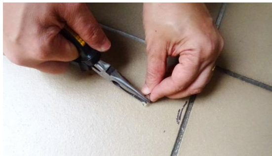
Imagen 6: Bombilla y corte con pinza para obtener la lente
