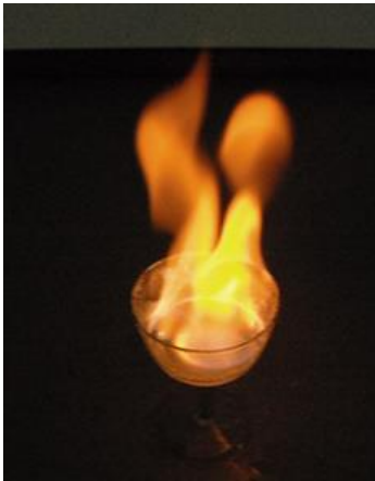
Foto 10. Luz de sodio (NaCl con alcohol) y su espectro
