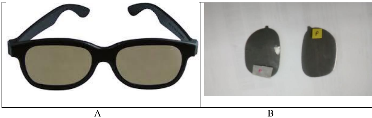
Foto 2. Gafas 3 D (A) y filtros polarizador-retardador (B)
