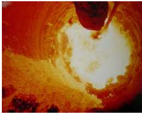
Figura 1. Proceso de clinkerización, imagen interna del horno [26].
