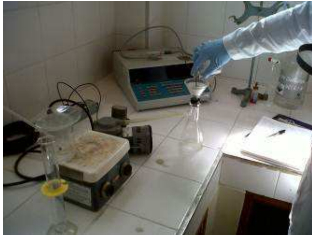
Figura 18. Montaje medición de CaO libre por titulación con etilenglicol.
