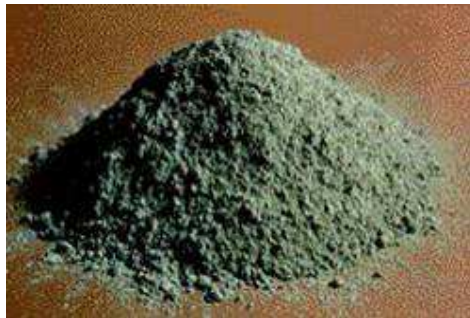
Figura 5. Cemento Portland: Producto de la etapa de Molienda [26].
