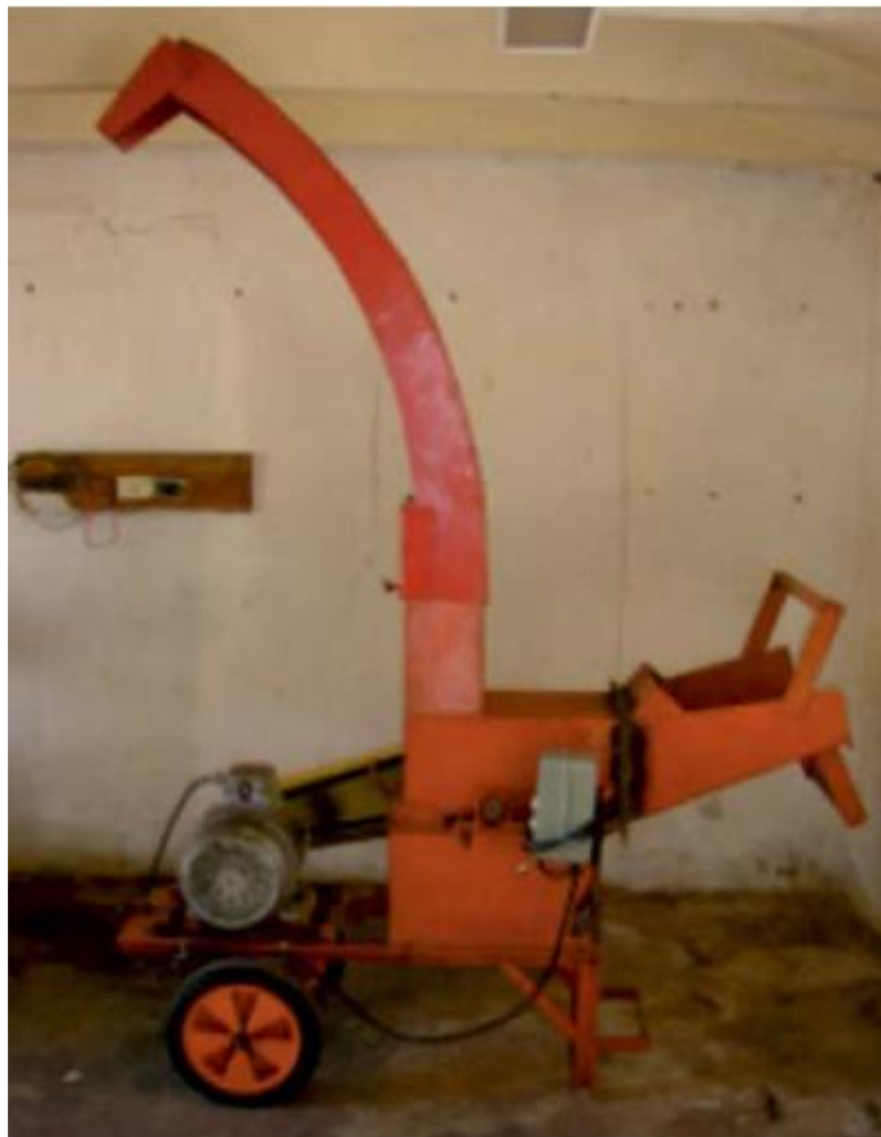
Figura 12. Vista general de la picadora o molino forrajero de tambor [43]
