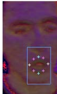
Figura 3.12: Resultado del algoritmo de detección del contorno de la boca.
