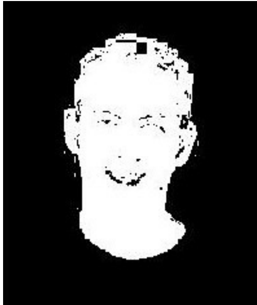
Figura 2.2: Segmentación mediante los umbrales para H y S.
