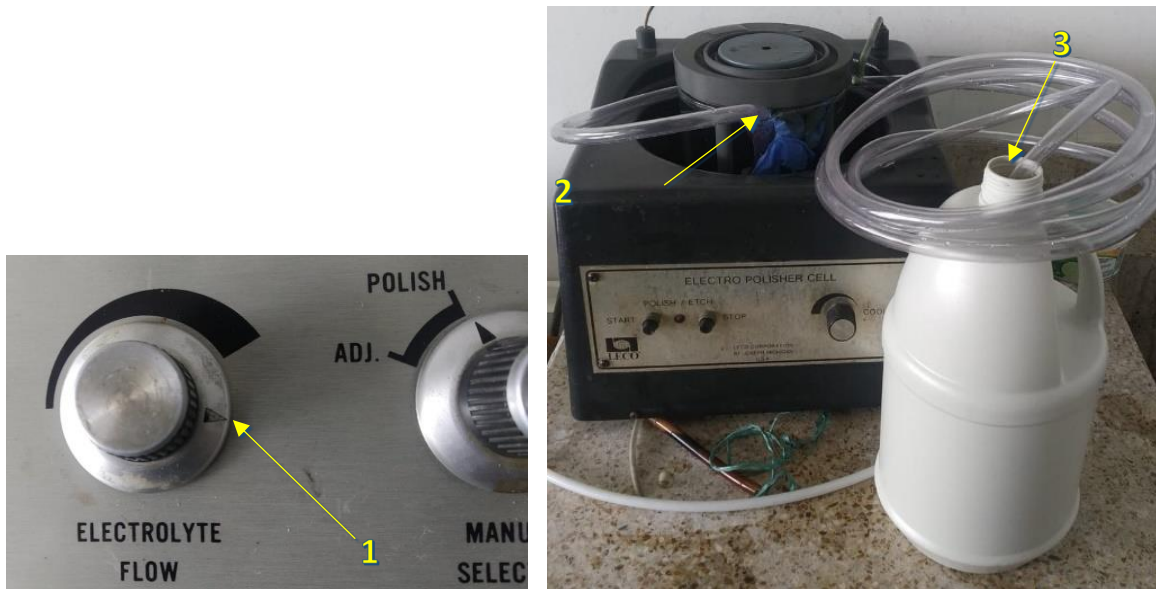
Figura 2-15. Posición del control del caudal (1) en consola (izquierda) y adaptación para extracción de electrolito para cálculo de caudal (derecha): entrada de manguera a la celda para conexión al retorno de la bomba (2) y almacenamiento del electrolito extraído (3).
