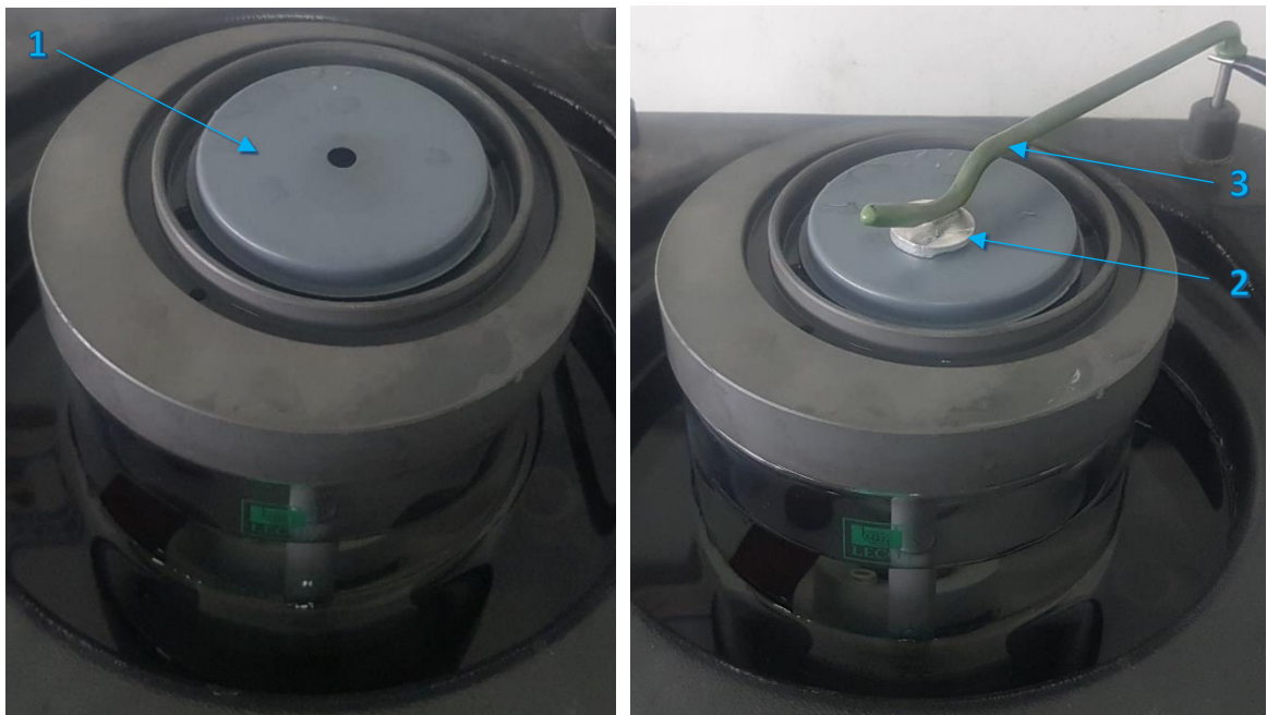
Figura 2-13. Montaje de la celda con máscara de exposición de la probeta (1) (izquierda) y probeta (2) ubicada sobre la máscara con conexión (3) sobre la misma (derecha).
