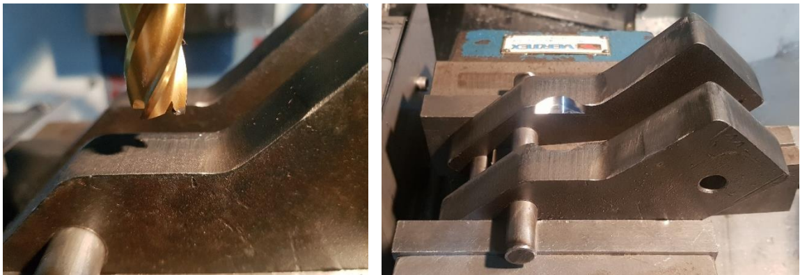
Figura 2-4. Maquinado de mordazas a medida para sujeción de probetas.
