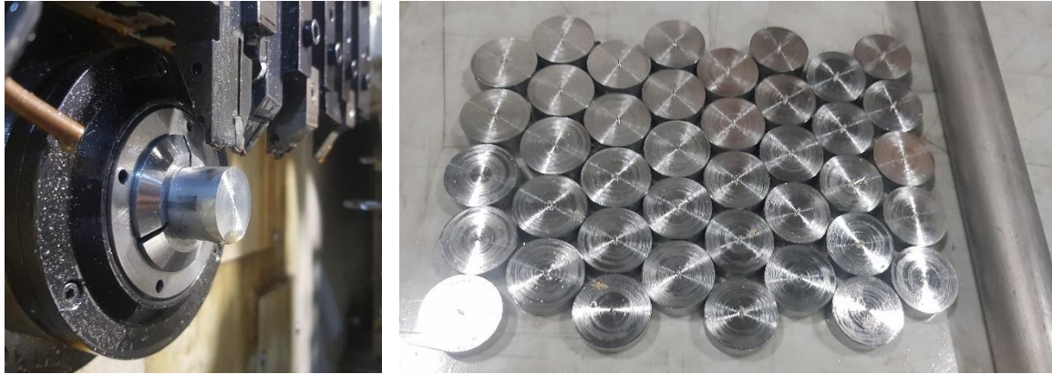
Figura 2-8. Preparación de material para probetas.
