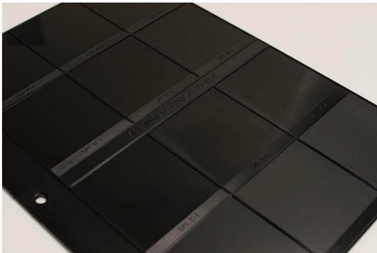
Figura 1-2. Patrón de la guía AR-106 moldeado en ABS [6].
