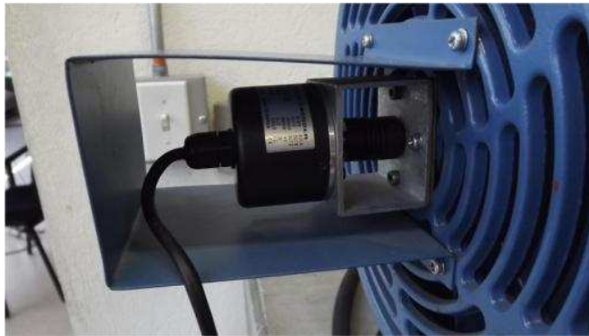
Figura A1.3. Encoder acoplado al eje del motor de riel.
