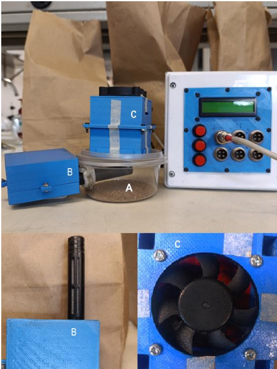
Figura 3. 1 Montaje de equipos para la medición de los patrones de gases emitidos por las muestras de suelo urbano. Se describen los equipos: A. Cámara Dinámica Abierta, permite el intercambio de gases entre el interior de la cámara y el ambiente, garantizando que los gases emitidos por el suelo sean transportados fuera de la cámara para su medición. B. sensor \text{CO}_2 (ppm) en forma tubular el cual permite en paso del gas a través de sus aberturas C. Sensor \text{CO} , \text{NO}_2 o \text{NH}_3 (ADC) que permite el paso del gas emitido por el suelo a través de la ventilación.
