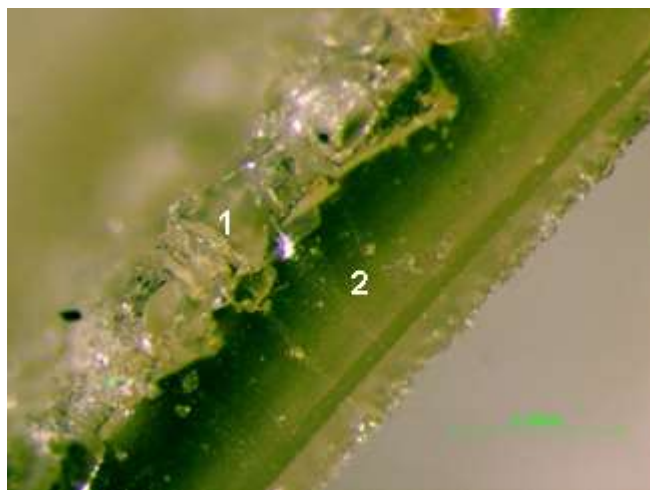
Figura 6-6 Imagen del recubrimiento protésico obtenida mediante estereoscopio, se observa un área rugosa e irregular (1) dada por un tratamiento de superficie (parte externa de una prótesis mamaria) y una zona lisa (2), la medida del espesor se realiza mediante estereoscopio con 12x de aumento.
