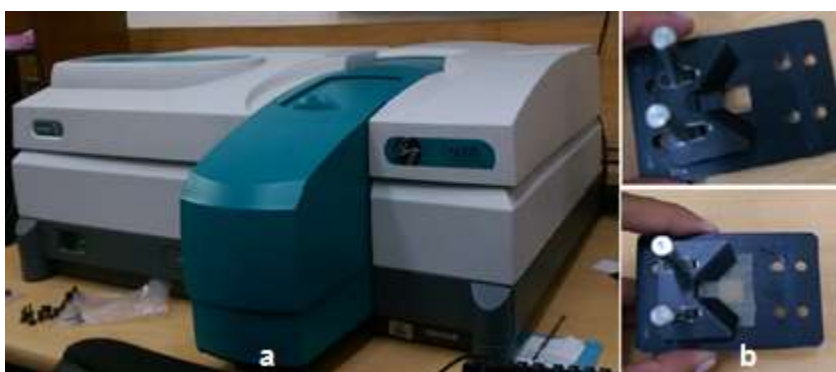
Figura 6-8 Espectrofotómetro VARIAN Cary 5000. a) A la izquierda: vista general, b) A la derecha: soporte con muestra.
