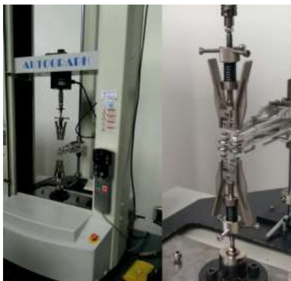
Figura 6-7 Máquina Universal de Ensayos. Izquierda: vista general, derecha: mordazas que sujetan las muestras a ensayar y extensómetro.
