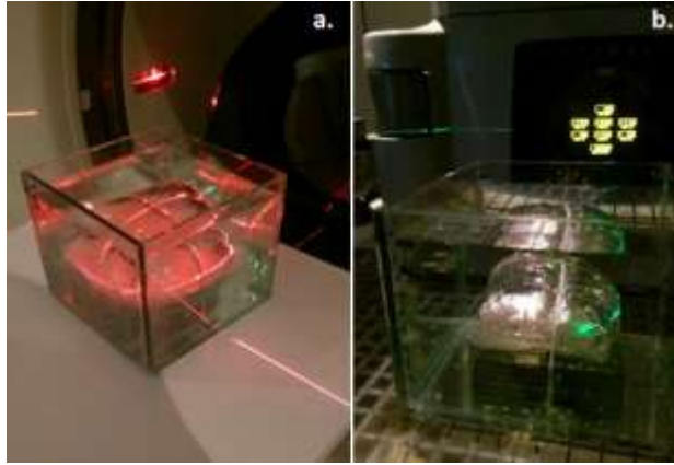
Figura 6-2 Posicionamiento de muestras en a. Tomógrafo, b. Acelerador derecha.
