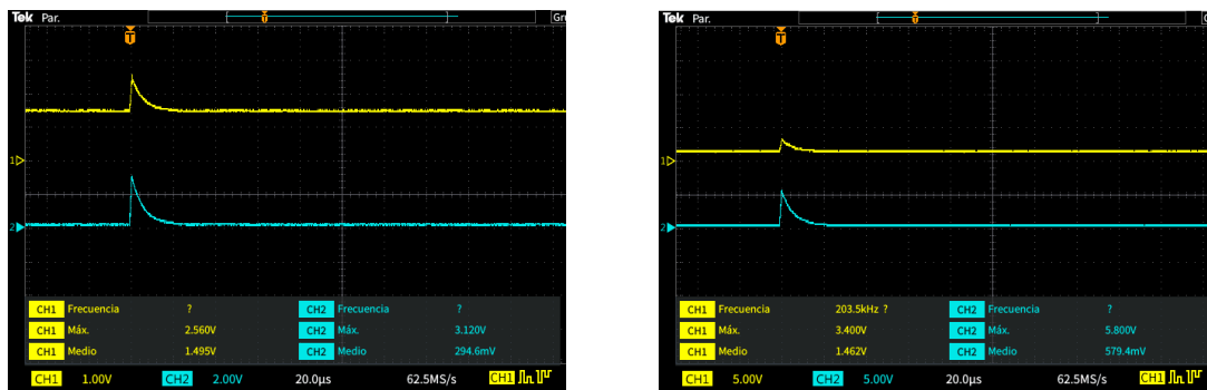
Figura 25. Respuesta del sistema ante Impulsos rápidos. Línea Cían: Entrada, Línea Amarilla: Salida, a) 5 V, b) 2.5 V Fuente: Elaboración propia
