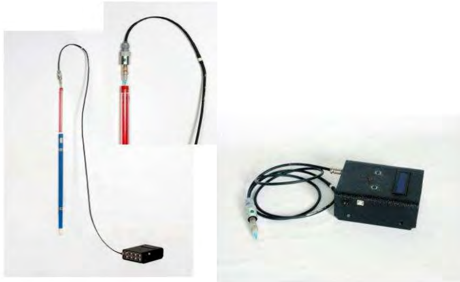
Figura 3.3 Tensiómetros con medidor electrónico de vacío y sistema para registro de lecturas.
