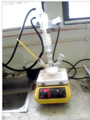
Figura 2-11. Montaje para la determinación del poder de hinchamiento, Sólidos solubles y Absorción de agua
