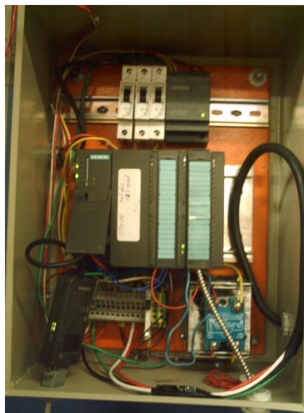
Figura 3. 3. Elementos del sistema de cocción controlado. a. Montaje del sistema. b. Tanque de cocción. c. PLC.
