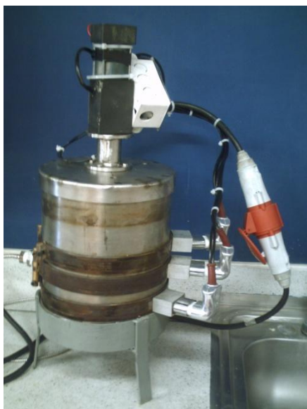
Figura 3. 3. Elementos del sistema de cocción controlado. a. Montaje del sistema. b. Tanque de cocción. c. PLC.
