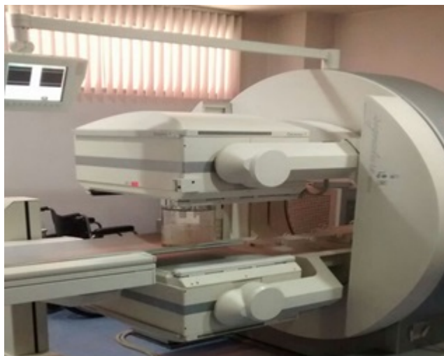
Figura 3-3: Gammacámara del servicio de medicina nuclear del Instituto Nacional de Cancerología E.S.E con el posicionamiento del Phantom Jaszczak mostrado en la Figura 3-2 para la obtención de las imágenes
