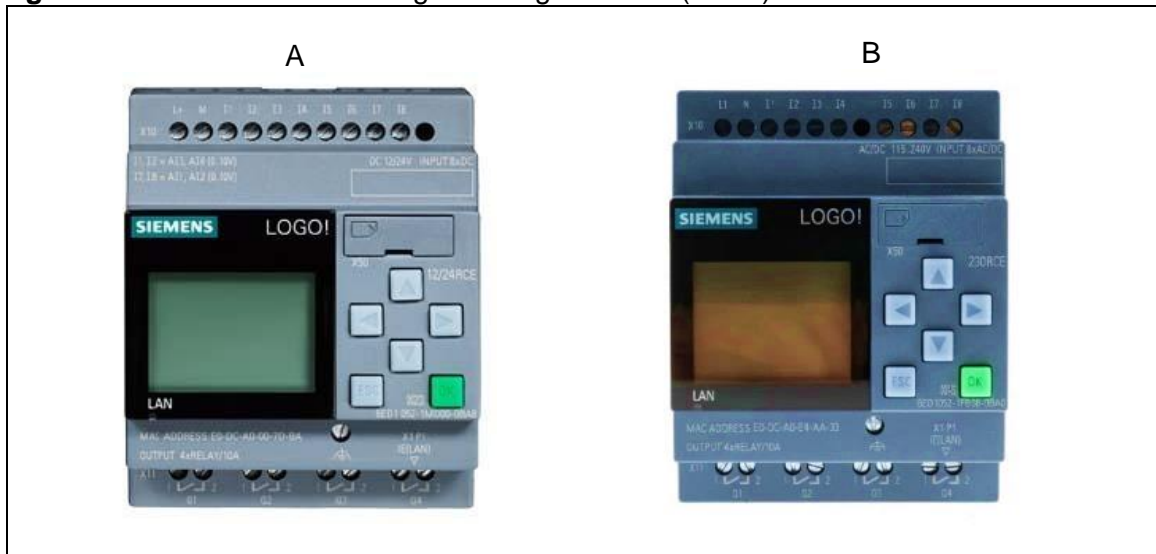
Figura 3-6: Controladores Lógicos Programables (PLCs) del SITA
