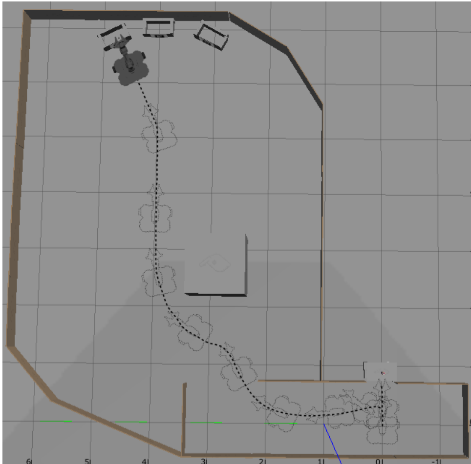
Figura 5-33: Recorrido de robot móvil en una misión logística.
