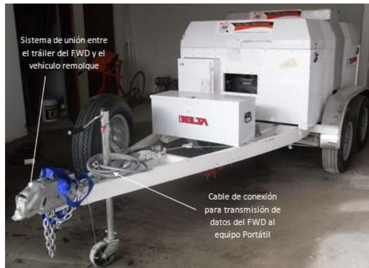
Figura 1. Equipo FWD JILS-20 de propiedad de la Universidad Nacional de Colombia, sede Bogotá.
