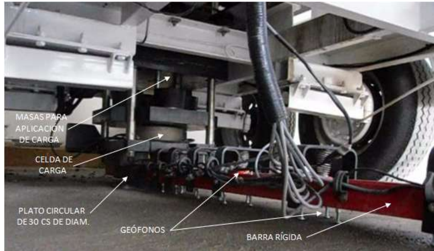
Figura 11 Componentes básicos de medición del FWD – JILS 20 propiedad de la Universidad Nacional de Colombia – sede Bogotá.
