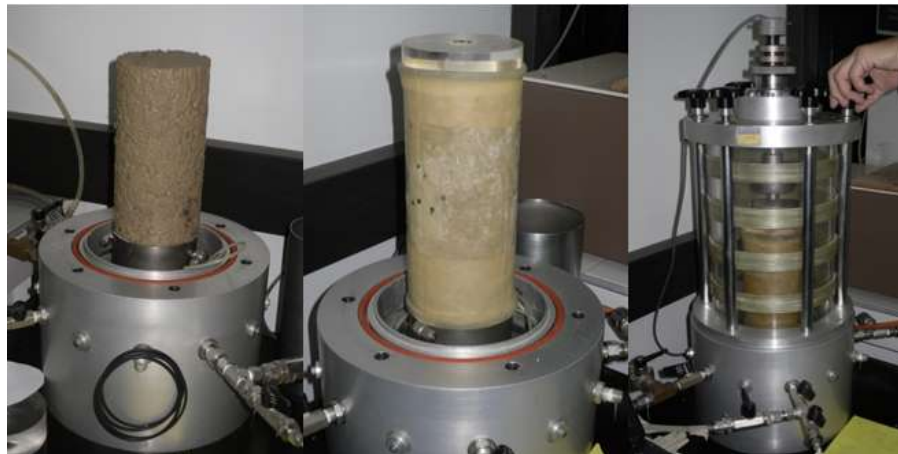
Montaje de la probeta en la cámara triaxial.
