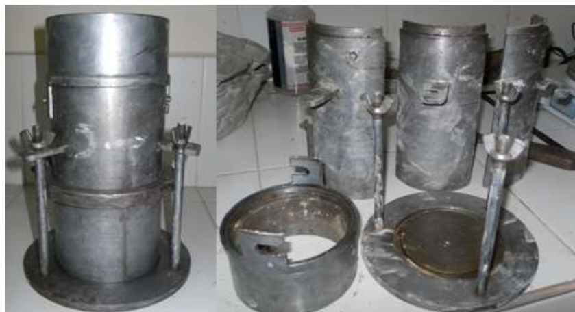
Moldes para la conformación de las probetas.
