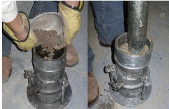
Montaje de la probeta en la cámara triaxial.
