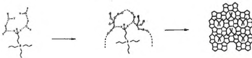
Figura 3. Mecanismo de crecimiento de cristal de Si-ZSM-5 [3].
