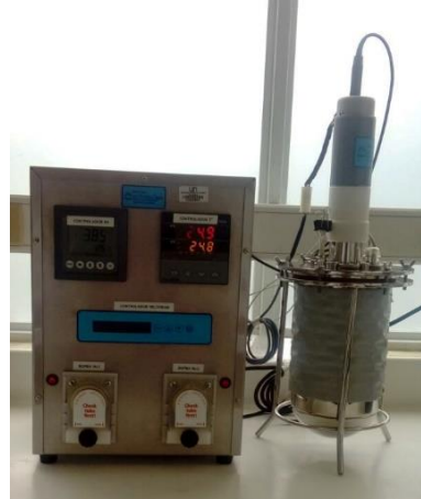
Figura 2-1: Bioreactor de 3 L utilizado para el modelamiento de la fermentación alcohólica de miel de abejas
