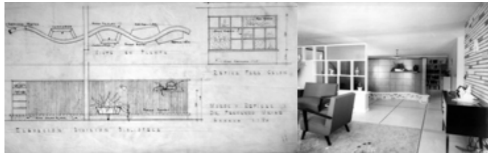
193 Casa Estrada. Celosía metálica entre salón y circulación.
