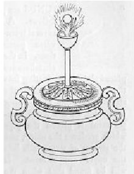
Figura 2.4. Chorro de vapor que sostiene una esfera.
