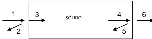
Figura 7. Movimiento de un haz de luz en un sólido
