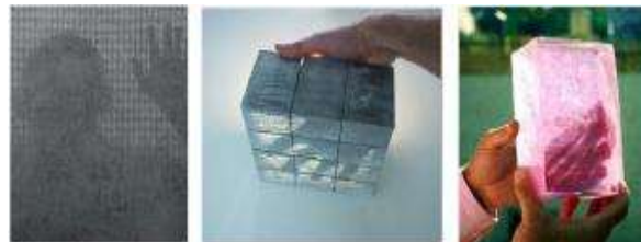
Figura 2. Tres tipos de concreto translúcido, de izquierda a derecha: Pixel Panels, LITRACON, Producto Mexicano Ilum.
