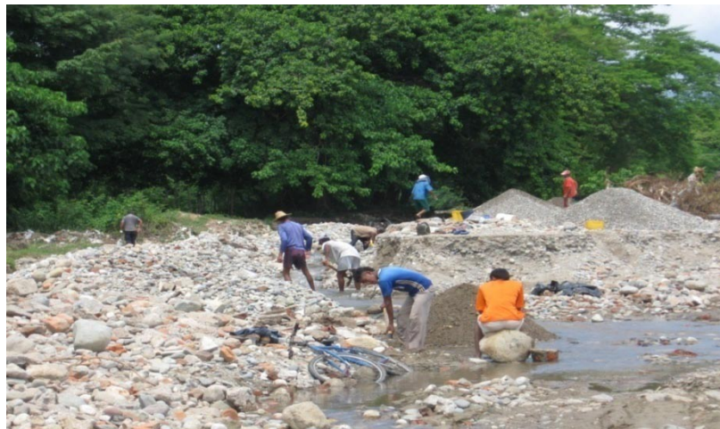
Figura 29: Forma de extracción manual de material de arrastre
