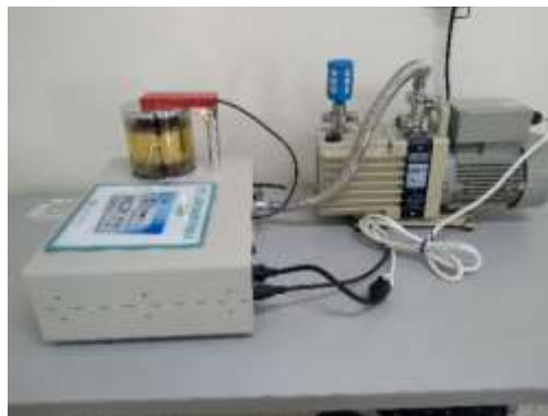
Figura 16-4 Recubridor para el equipo SEM
