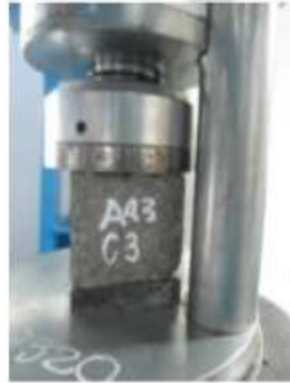
Figura 18-4 Cubo de mortero ensayado a compresión
