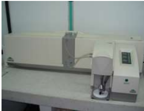
Figura 12-4 Equipo utilizado para Granulometría Láser. Universidad del Valle
