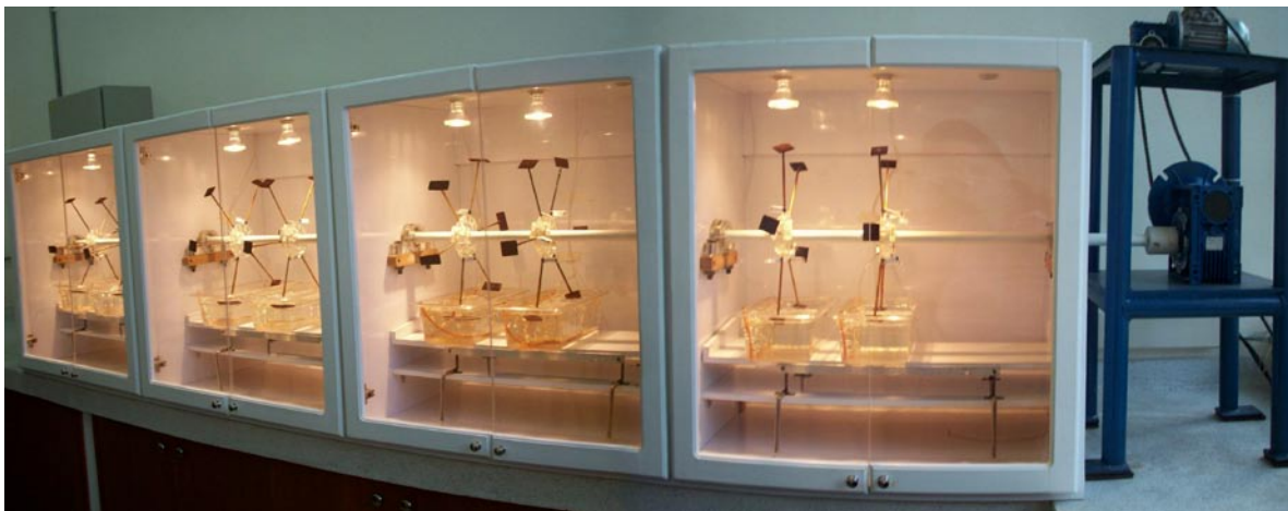
Figura 9. Vista completa del montaje del Ensayo del Cebelcor realizado en la Universidad Nacional de Colombia.
