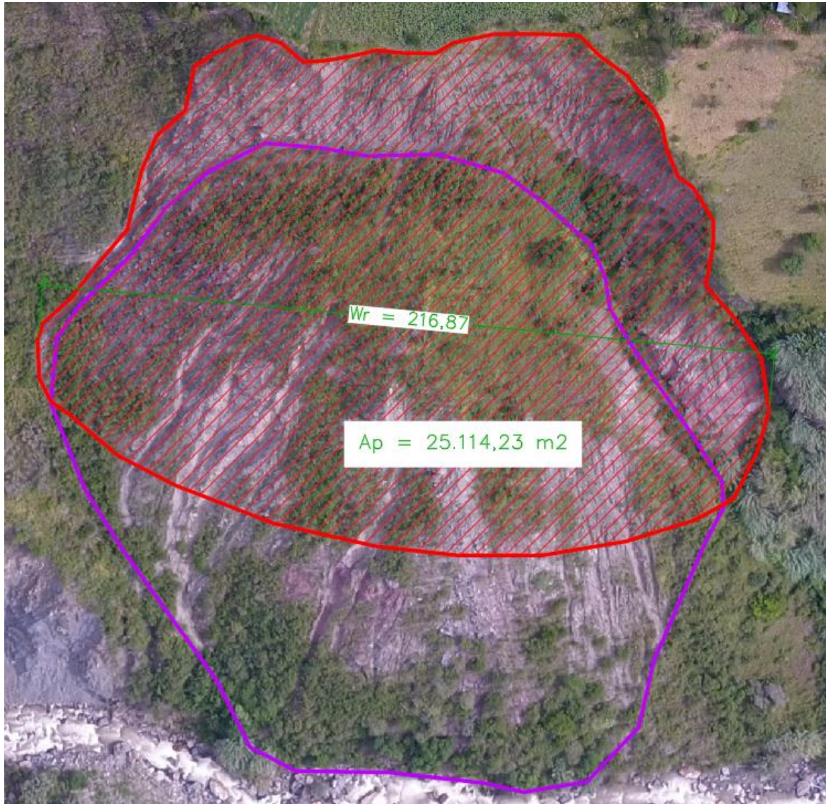
Figura 3-6. Toma de las medidas del área de la superficie de falla ( A_p ) y su ancho ( W_r ) en m^2 y m respectivamente. Evento Z6_20_5 (Carcasí, Santander)
