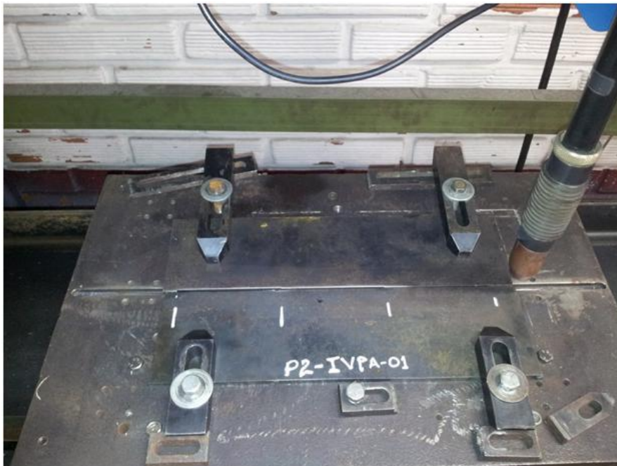
Figura 5. 4. Montaje de soldadura en junta.
