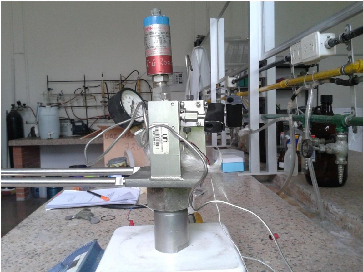
Anexo 1. Reactor tipo autoclave utilizado para los ensayos catalíticos.
