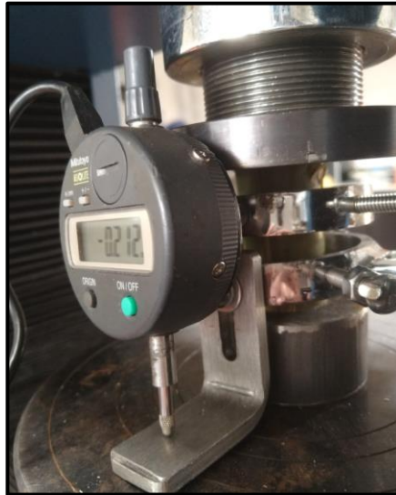
Figura 31. Montaje de dispositivos- ensayo compresión paralela a la fibra.
