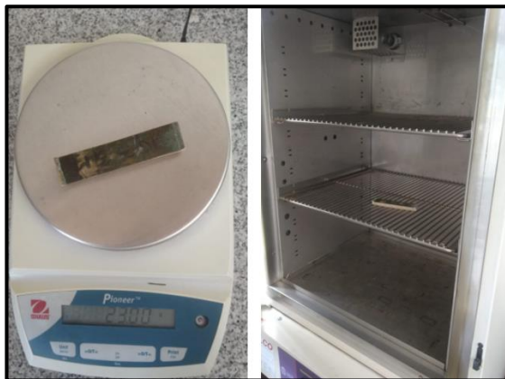
Figura 22. Secuencia de elaboración de probeta, pesaje y secado.
