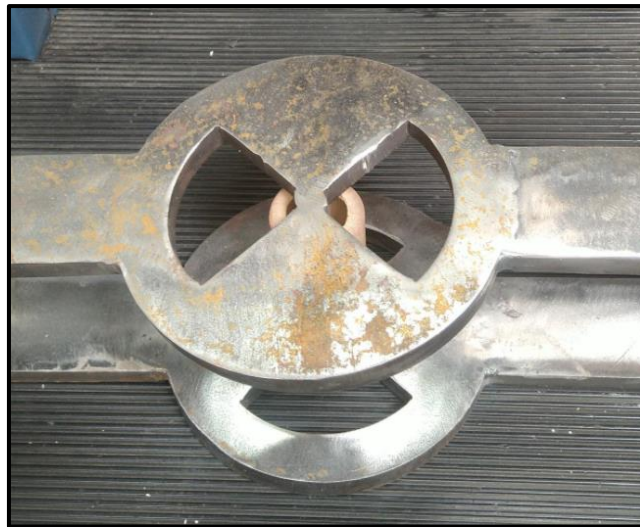
Figura 37. Montaje de ensayo de corte.
