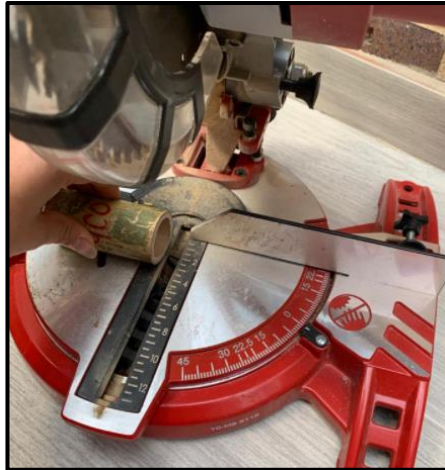
Figura 17. Corte de probetas con sierra circular
