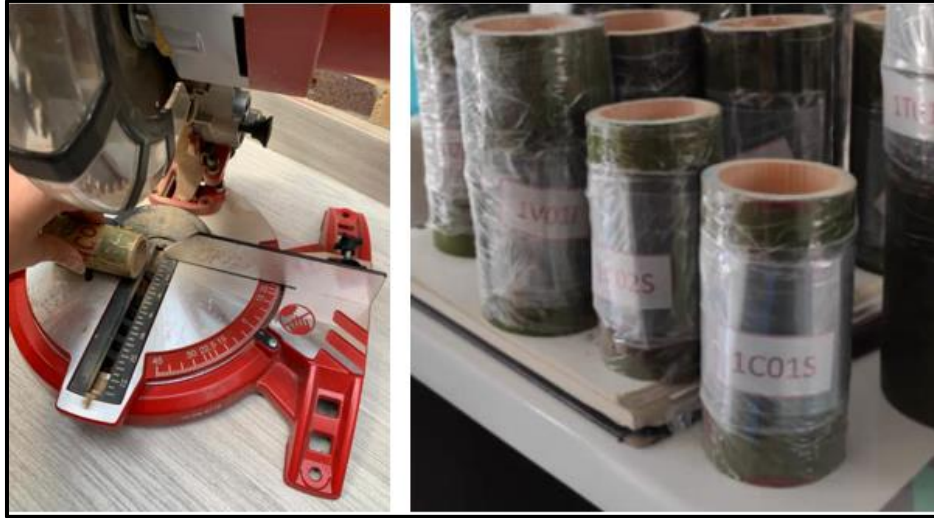
Figura 29. Preparación de probetas para ensayo de compresión paralela.
