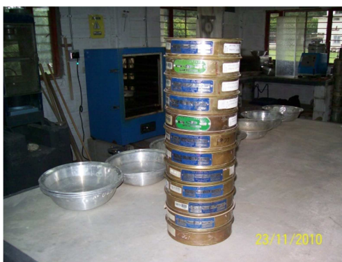
Foto 1. Equipos para realizar gradaciones: Tamices, Horno, bandejas, balanzas
