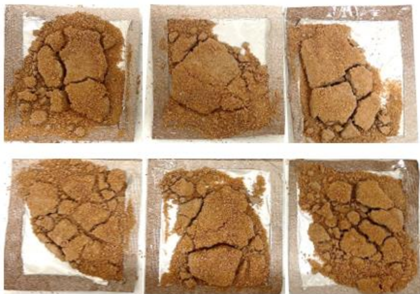
Figura 2-1 Evaluación visual de muestras sometidas a ciclos de horno-congelador. Archivo particular.
