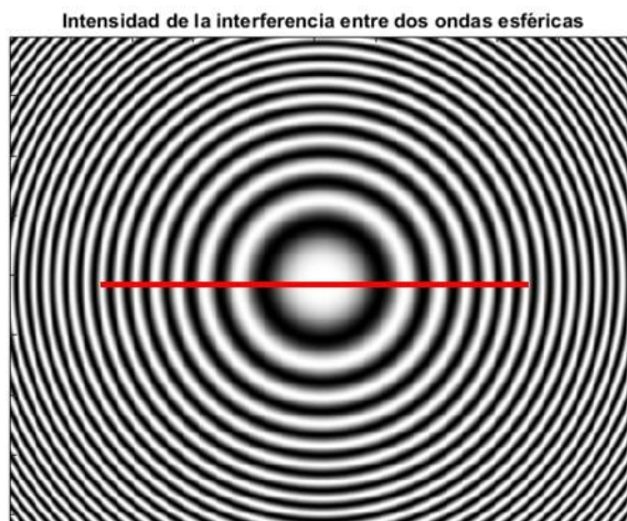
Figura 5-12 Interferograma resultante de la suma de dos ondas esféricas 10
