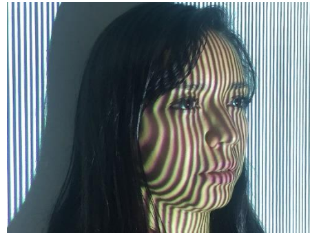
Figura 5-19. Patrón de franjas proyectado sobre un rostro. La topografía deforma las franjas.
