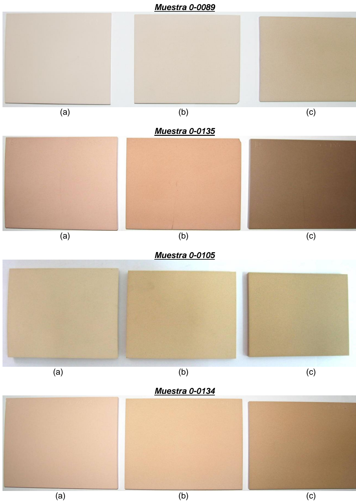
Figura 4.2: Probetas cocidas a tres temperaturas diferentes de las muestras 0-0089, 0-0135, 0-0105, 0-0134; (a) 1050°C (b) 1100°C (c) 1150°C
