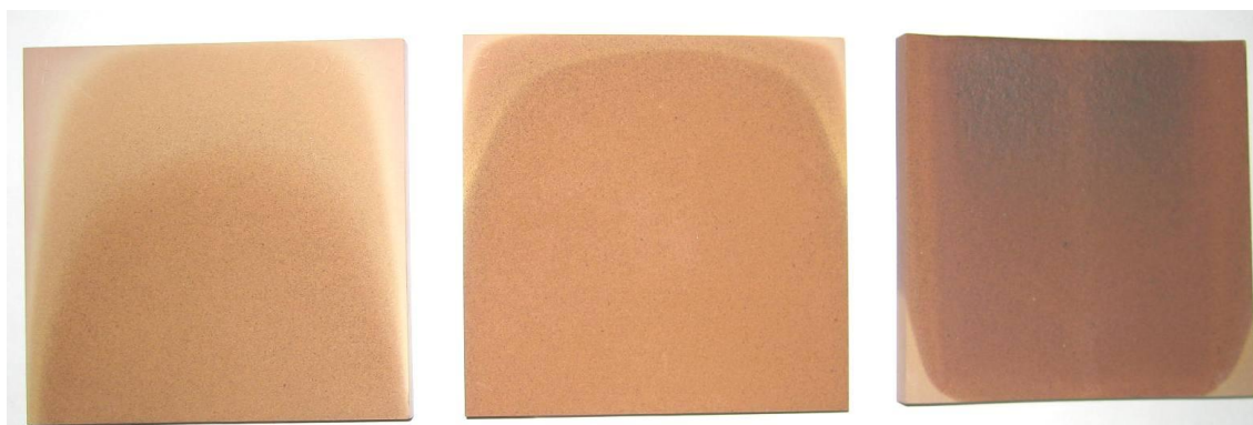
(a) (b) (c) Figura 4.36: Probetas cocidas a tres temperaturas diferentes de la muestra 0-0093 (a) 1050°C, (b) 1100°C, (c) 1150°C
