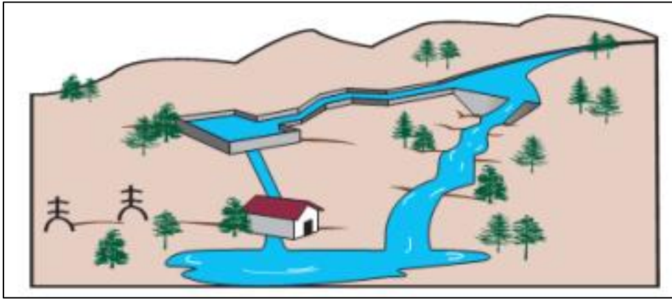
Figura 2-2. Central hidroeléctrica a filo de agua. (IDAE, 2006)
