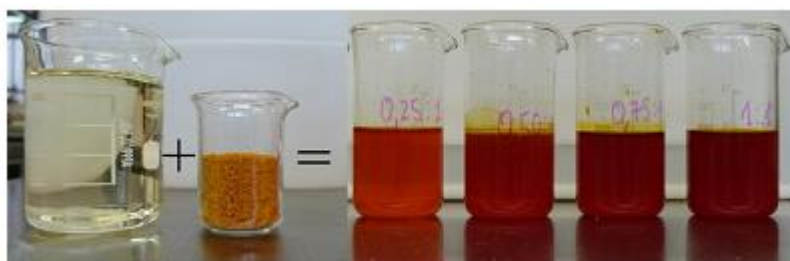
Figura 3-2 AVP obtenido en diferentes proporciones de extracción sólido-líquido: 0,25:1, 0,5:1, 0,75:1 y 1:1 w/v, polen:aceite vegetal.
