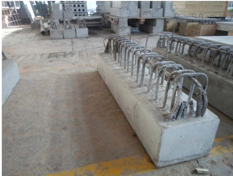
Figura 27. Viga de borde
