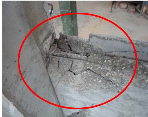
Figura 47. Falla por aplastamiento en la zona derecha de la probeta
