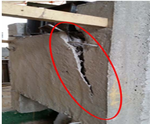
Figura 57. Modo de falla de la probeta 3.2
