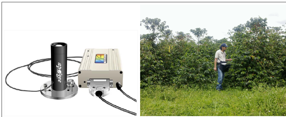
Figura 2.2: Espectroradiómetro EPP2000 (izq.) y medición (der.).
