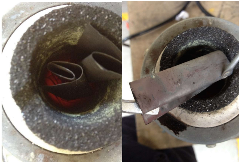
Figura 2-9: fundición de la hojalata de insecticida doméstico.
