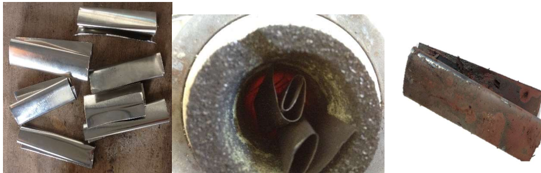
Figura 6-2: Muestra de la hojalata antes, durante y después de la prueba en horno eléctrico.
