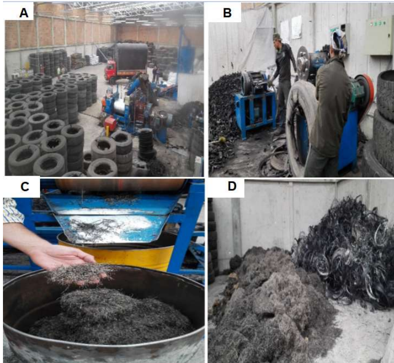
Figura 4-3: trituración de llantas: A) almacenamiento; B) trituración; C) separación de elementos metálicos y D) materiales obtenidos después de la trituración.
