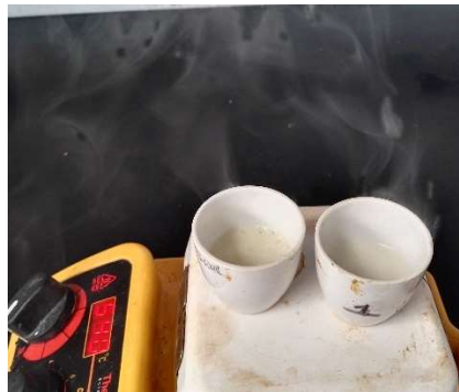
Figura 6-3: Muestra de dilución de pintura de la hojalata del envase de insecticidas en proceso de calentamiento.
