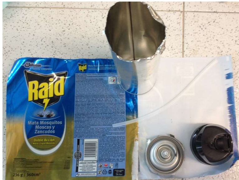
Figura 2-2: componentes de un envase de insecticida doméstico.
