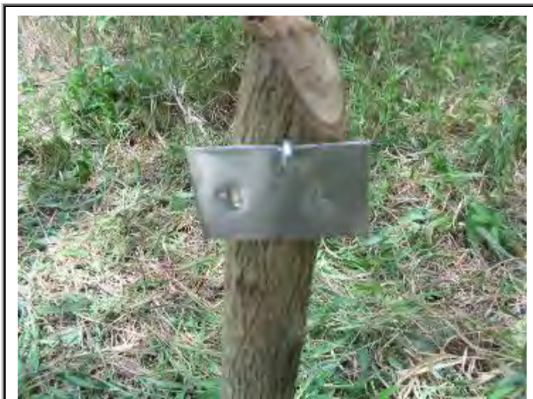
Figura 37: Placas de Aluminio en las estacas para la marcación de los Bloques de Muestreo.
