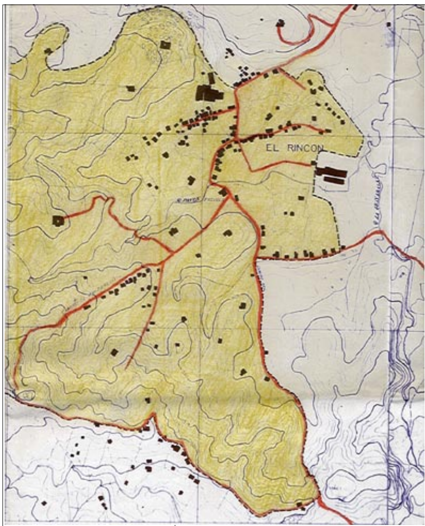
Plano fincas de Belén Rincón. El color amarillo muestra el perímetro actual del barrio; el rojo, las vías principales, y el negro, las construcciones.
