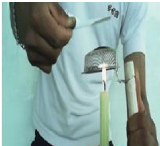
Foto 10. Transmisión de calor y temperatura de ignición de un material
