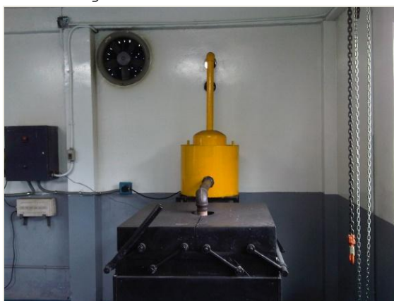
Figura 2-1: Fotografía Horno Piloto de Coquización
