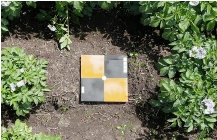
Fig. 4.2 Marcador usado para identificar los puntos de control levantados con la estación total.
