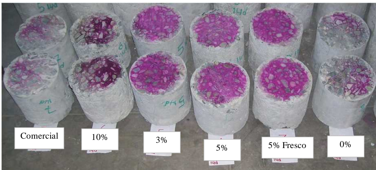
Figura 75 Probetas de hormigón reveladas con fenolftaleína para detección de zonas carbonatada
