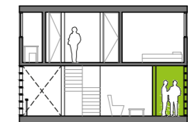
Células del bloque B de Pedregulho. Sección.
