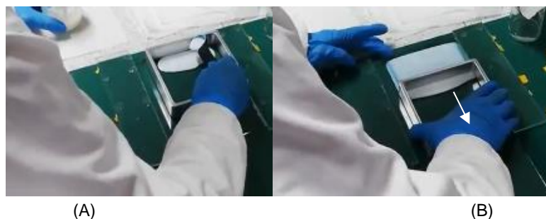
Figura1- 3: Aplicación para hacer película de dispersión polimérica o de pintura: (A) al agregar la dispersión y (B) al esparcirla sobre el sustrato.
