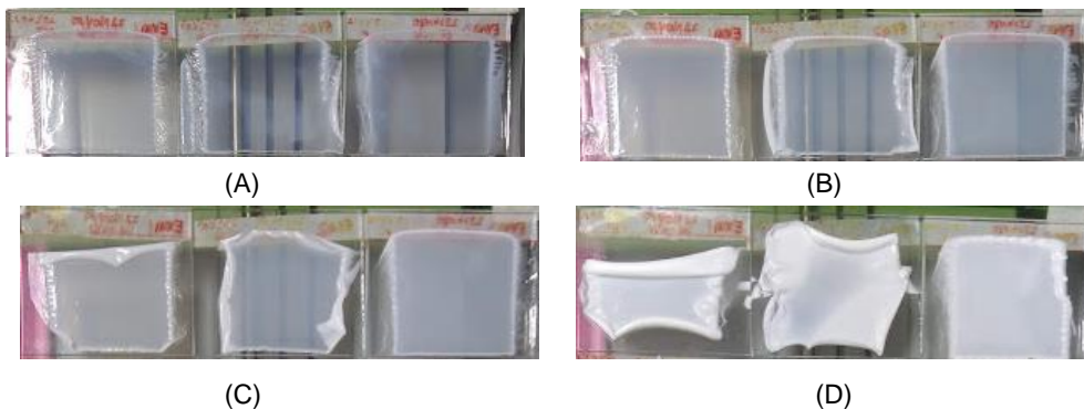
Figura 4- 17: Imágenes de las películas a diferentes tiempos de inmersión en agua, de las dispersiones EVA, TME y TMA: (a) 1h , (b) 3h, (c) 5h y (d) 24h.
