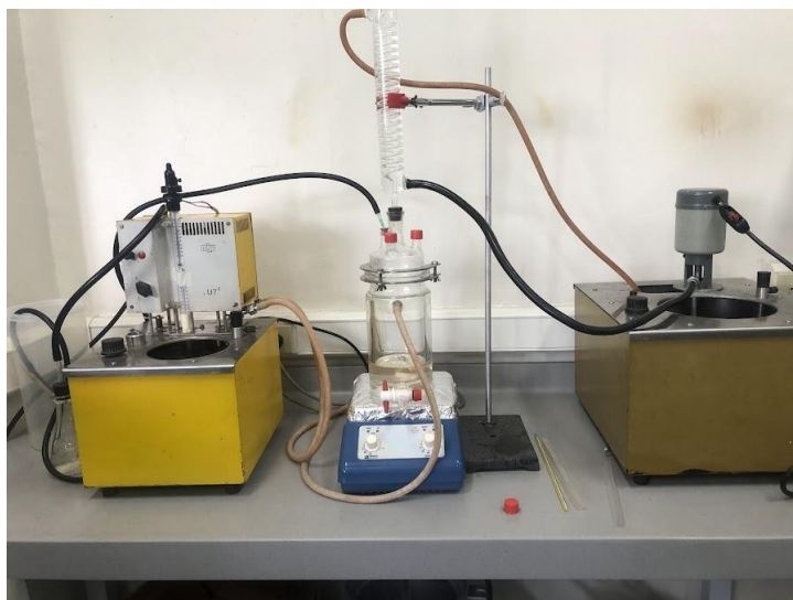
Figura 40 Anexo 1. Montaje para la síntesis de hidrogeles
